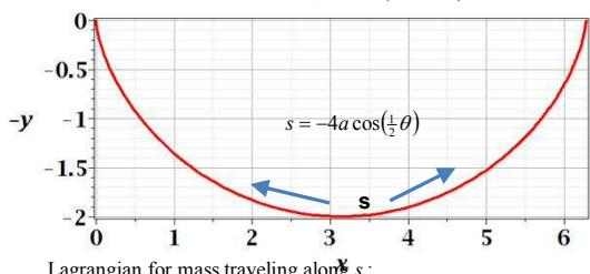
$$L(s(t), \dot{s}(t)) = \frac{1}{2} m \dot{s}^2 - mg y = \frac{1}{2} m s^2 - mg 2a \left( 1 - \left( \frac{s}{4a} \right)^2 \right)$$
