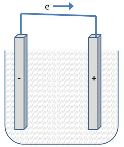
Negative electrode (Pb):  $\mu(SO_4^{-2})$ Pb + $SO_4^{-2} \rightarrow PbSO_4 + 2e^-$
